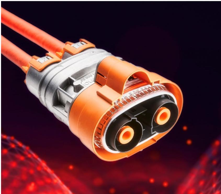
Steckverbinder aus Durethan BKV30FN04 für Kabelbäume von Elektromodellen eines europäisch-amerikanischen Autoherstellers. Das halogenfrei flammgeschützte Polyamid 6 ist auch in hellen Farben wie Orange (RAL 2003) oder Gelb einfärbbar und zeichnet sich durch eine hohe Festigkeit und Zähigkeit aus.
