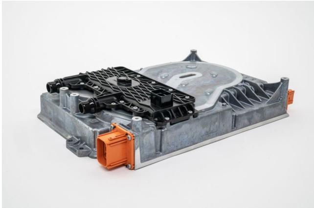
Die schwarze Abdeckung des Onboard-Batterieladegeräts besteht aus dem mit 50 Gewichtsprozent Kurzglasfasern hochverstärkten Durethan BKV50H3.0 von LANXESS.
