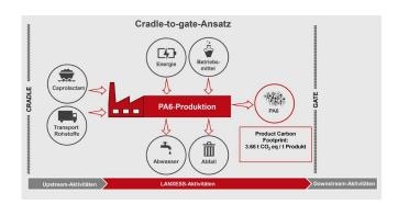
Die Werte für den CO<sub>2</sub>-Fußabdruck unter anderem von Polyamid 6-Basiskunststoff wurden nach dem Standard ISO 14067:2018 ermittelt. Berücksichtigung fanden alle wesentlichen Emissionen, die anfallen, bis das Produkt das Werkstor von LANXESS verlässt (cradle-to-gate).
